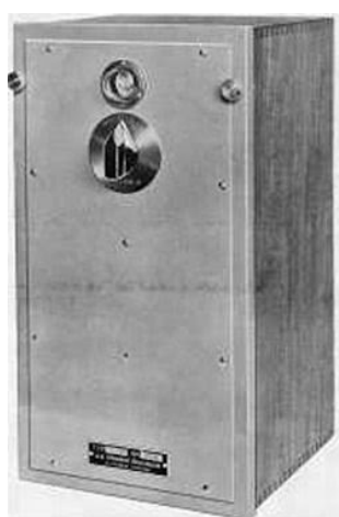
Late-30s "Tönende Löschfunken" emergency spark transmitter
